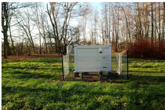
Rys. 5. Mobilna stacja automatyczno-manualna monitoringu jakości powietrza w Goczałkowicach-Zdroju
