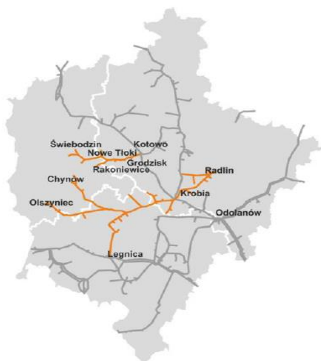
Rysunek 11. System przesyłowy gazu ziemnego zaazotowanego
